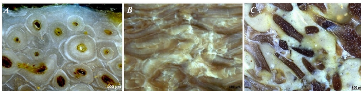
Разные типы минерализации костных остатков Кундурского местонахождения: A – Слабая степень минерализации; B – Средняя степень минерализации (внутрикостная деформация); C – Высокая степень минерализации (разрастание кристаллических фаз)
